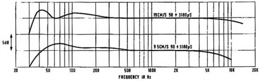
FIG. 3 SONY TC630D RECORD-PLAY FREQUENCY RESPONSE (-20dB REF 32mH/mm)
