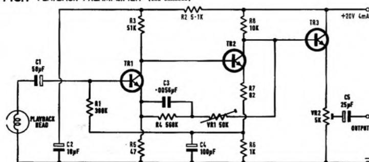
FIG. 2 RECORD AMPLIFIER (ONE CHANNEL)
