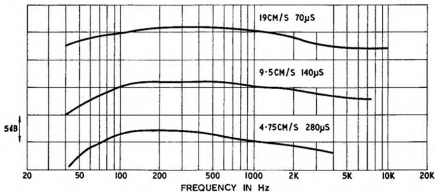
**FIG. 3 TANDBERG 64X RECORD / PLAY RESPONSE (AUX. INPUT TO LINE OUT)**
