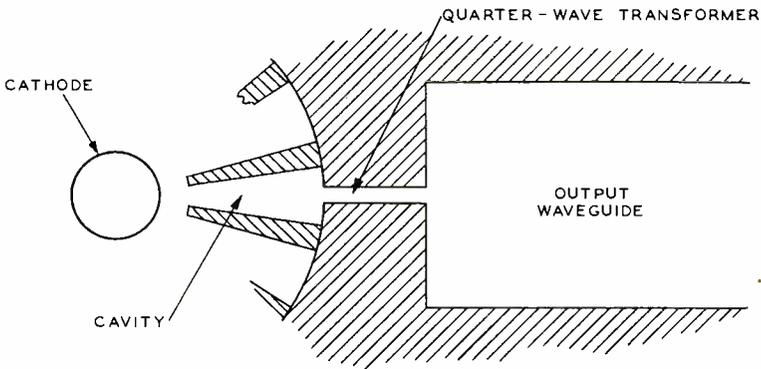
Fig. 1—Waveguide-output magnetron.
