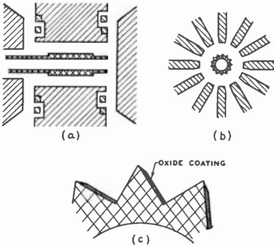
Fig. 4— Grooved cathode.
