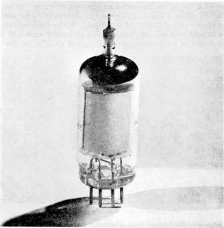
Fig. 14—1654 Rectifier Tube.
