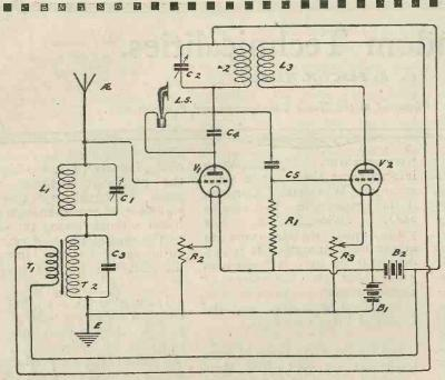
Fig. 1 .- The ST75 Circuit.
