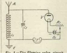
Fig. 1 .- The Fleming value circuit.
