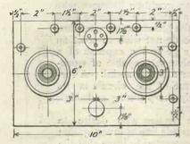
Fig. 5 .- Details of Panel.
