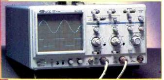
20MHz 2-CH OSCILLOSCOPE
