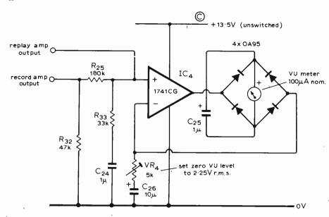
Fig. 6. VU meter circuit.
