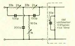
Fig. 7. Twin-T filter for 68kHz.
