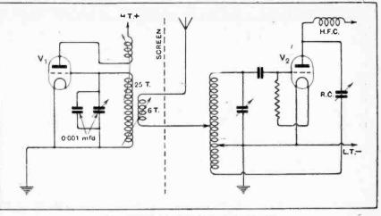
Fig. 1.- A separate valve rejector circuit.
