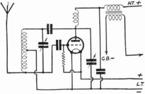
Fig. 213.—The Hartley Circuit.
