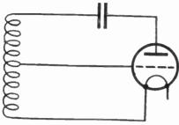
Fig. 55.—Autodyne Circuit.
