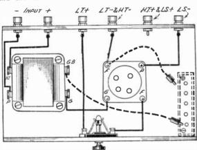
Fig. 121 .- A One-valve Amplifier.
