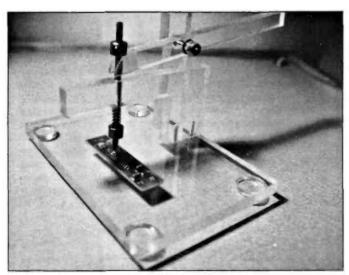
Fig. 7. An assembly jig.
