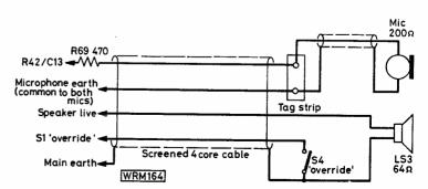
Fig. 7: Front door unit wiring diagram
