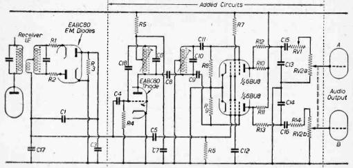
Fig. 6.-Sync separator and decoder circuit.
