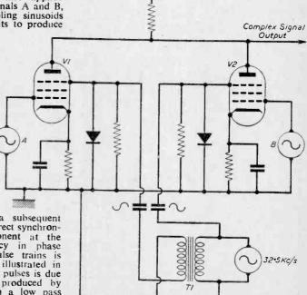
Fig. 3.-Basic encoding circuit.
