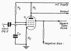
Fig. 3.-Basic "Gate" Circuit.
