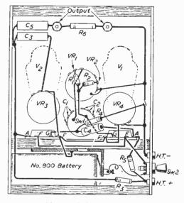
Fig. 3.-Wiring Diagram.
