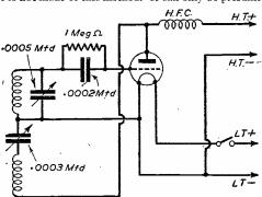
Fig. 1.-Oscillating Triode.
