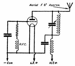
Fig. 3.—100 kc/s crystal oscillator.
