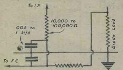
Fig. 3.-Decoupling the A.V.C. circuit.
