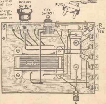
Fig. 3 .- Wiring diagram.
