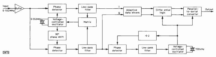
Fig. 7: DQPSK signal decoding.
