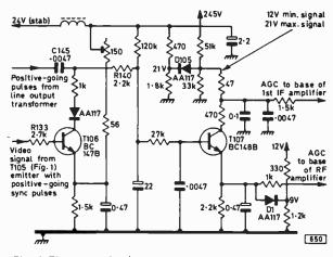
Fig. 4: The a.g.c. circuit.
