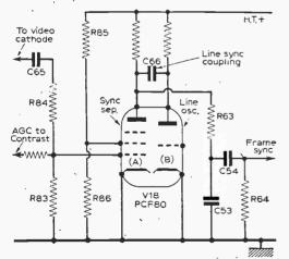
Fig. 26—Pye V200 sync separator. Component values: C65,  $0\cdot l\mu F$ ; R84,  $l0k\Omega$ ; R83,  $2\cdot 2M\Omega$ ; R85,  $47k\Omega$ ; R86,  $22k\Omega$ ; C66, l5pF, 750V; R63,  $220k\Omega$ ; C53, 220pF; C54,  $0\cdot 0l\mu F$ , R64,  $l50k\Omega$ .
