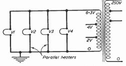
Fig. 55 .- Parallel heater circuit.
