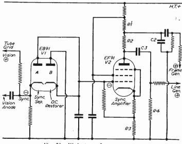
Fig. 20.-Diode type of sync separator.
