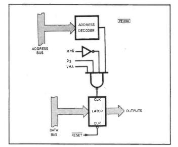
Fig. 3.8. Simple output port schematic
