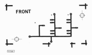
Fig. 4.8. Clock option p.c.b. layout (component-side)
