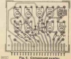
Fig. 6. Component overlay
