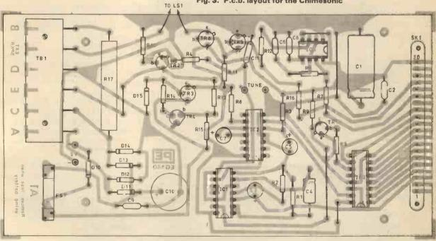
Fig. 4. Component overlay
