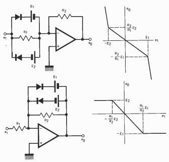
Fig. 4.9. Diode Limiter Circuit.
