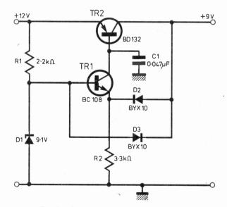
Fig. 1. Circuit of stabilised p.s.u.
