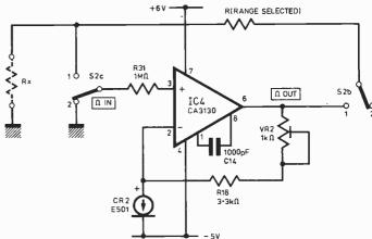
Fig. 4. Ohms Converter
