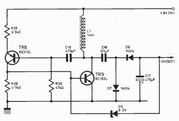
Fig. 5. DC-DC Converter
