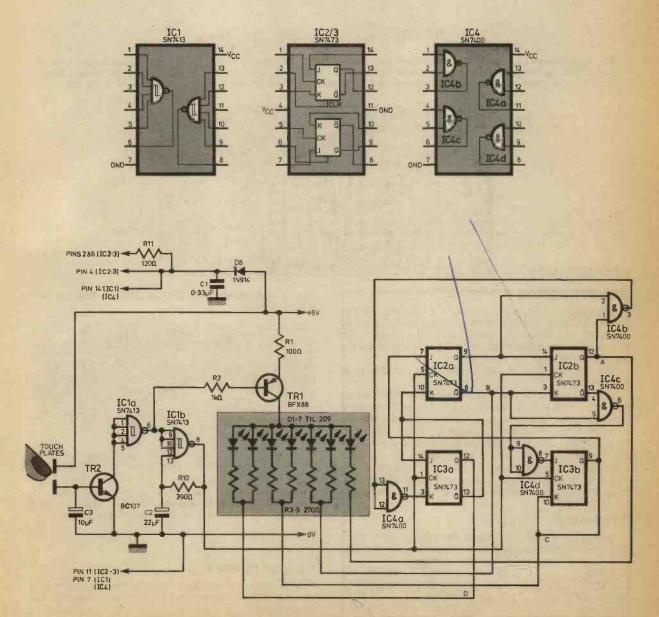
Fig. 1. Circuit of die and i.c. leadouts
