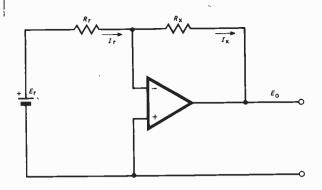
Fig. 1. Basic op. amp. circuit
