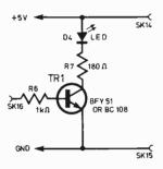
Fig. 8. Indicator using an I.e.d.
