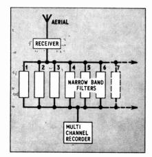
Fig. 3.10. A multi-channel spectrometer
