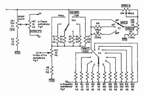
Fig. 8. Analogue parameter controls (stage one)
