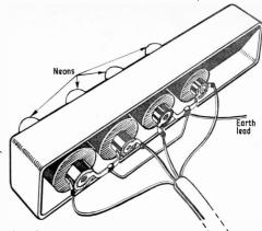
Fig. 1. Spark plug monitor wiring
