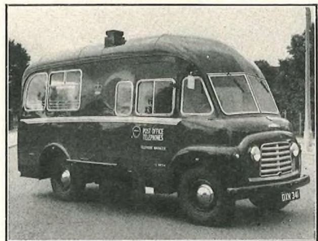
FIG. 3.—THE NEW CABLE TEST VAN.
