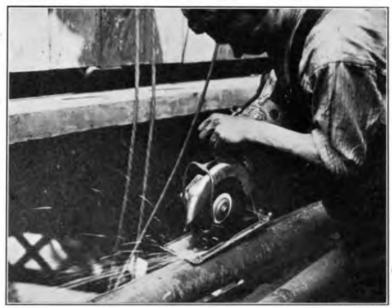
FIG. 4.—ELECTRICALLY-DRIVEN SKILSAW STEEL-CUTTING MACHINE IN OPERATION.
