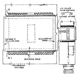
FIG. 11.—ELECTRON CAMERA.
