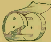
Fig. 8—Front roller construction
