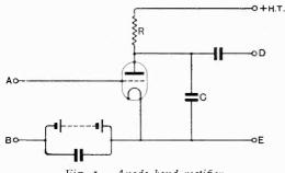
Fig. 1.—Anode bend rectifier.
