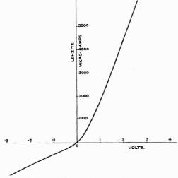
Fig. 5. (c.) Lenzite Crystal Rectifier.
