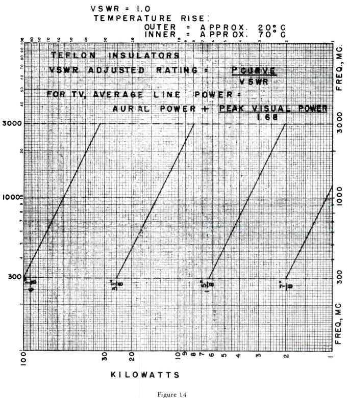
APPROXIMATE UHF POWER RATING NOMINAL 50 OHM AIR-DIELECTRIC COAXIAL TRANSMISSION LINE
