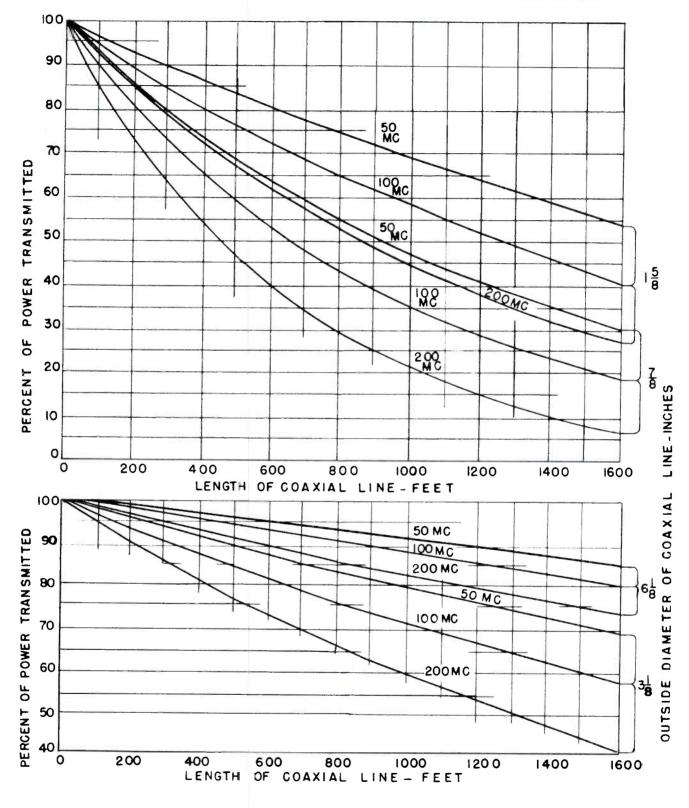
Figure 13 VHF TRANSMISSION LINE EFFICIENCY
