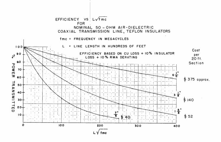
Figure 15 UHF LINE EFFICIENCY
