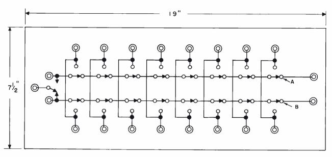
Figure 7a TK-1-A RELAY STRIP
