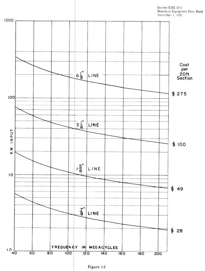
V.H.F. POWER RATING RMA STANDARD 511/2 OHM COAXIAL TRANSMISSION LINE (ALSIMAG BEADS)
