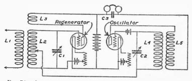
FIG. 74. ARMSTRONG SUPER-REGENERATIVE CIRCUIT. SUITABLE FOR RADIOPHONE RECEPTION.
