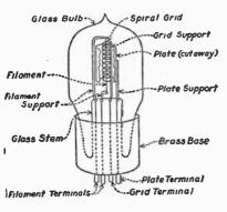
FIG. 47.—THE THREE ELEMENT VACUUM TUBE.
