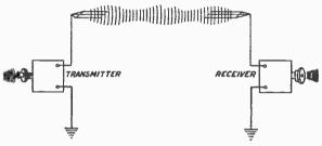
FIG. 1.-ELEMENTS OF A RADIO TELEPHONE SYSTEM.
