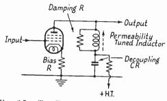
FIG. 6.7A. THE TUNED-ANODE SIGNAL AMPLIFIER
