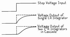
FIG. 5.6B. INTEGRATOR VOLTAGE OUTPUTS
