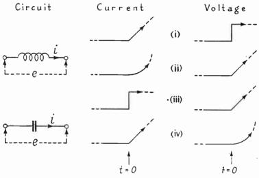
FIG. 2.3A. TRANSIENT OPERATION OF SIMPLE CIRCUITS
