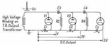
FIG. 3.10G. THE RC-COUPLED HALF-WAVE CASCADE MULTIPLIER
