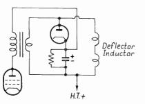
FIG. 4.10F. BASIC H.T. "BOOST" CIRCUIT
