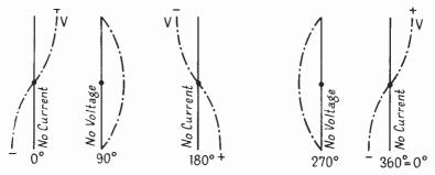
FIG. 9.2A. VOLTAGE AND CURRENT DISTRIBUTION ALONG A HALF-WAVE DIPOLE AT INSTANTS SPACED 90° THROUGHOUT THE CYCLE
