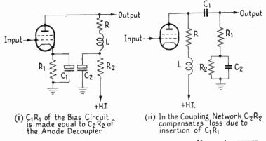
FIG. 6.4G. LOW-FREQUENCY COMPENSATION OF THE VIDEO AMPLIFIER
