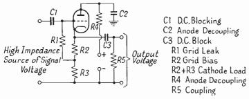
FIG. 2.9B. A TYPICAL PRACTICAL CATHODE-FOLLOWER CIRCUIT
