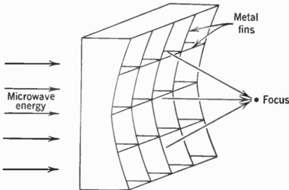
FIG. 15. Metal-lens antenna.
