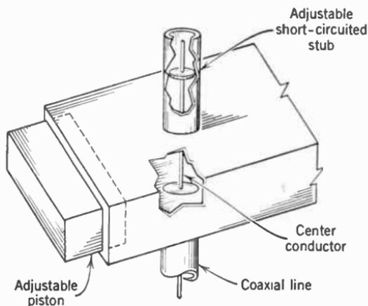
FIG. 12. Wave-guide coupler.
