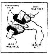
FIG. 15-Demagnetizing phone poles.
