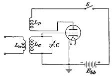
FIG. 10-4.- A fundamental oscillator circuit.
