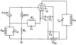
FIG. 10-21.-A tri-tet oscillator circuit.
