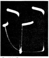
Fig. 13.4.—Dynatron output voltage.
