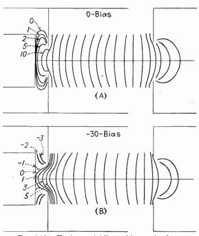
Fig. 6.19.—Equipotential lines of immersion lens.
