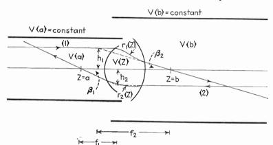
Fig. 5.1.—The fundamental trajectories.
