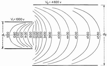
Fig. 6.2.—Equipotential line plot of bipotential lens.
